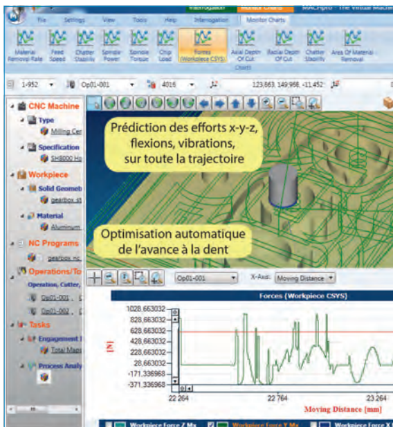
13 Le logiciel MACHpro, simulant forces x-y-z, flexions, vibrations, pendant l'usinage
